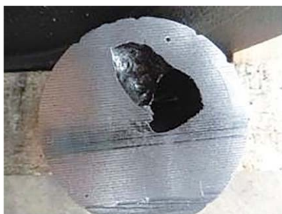
図7 空気断熱押湯の切断図（頭頂部に大きく引け発生）
